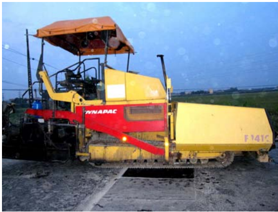
Máy rải Dynapact F141C của Cienco6 đã được sử dụng cho đoạn rải thử
