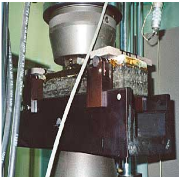
Thí nghiệm mỏi vật liệu thực hiện trong thiết bị động, tiến hành ở 18°C
