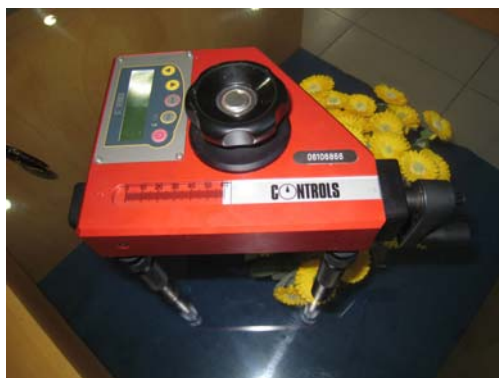
Thiết bị thí nghiệm nhỏ Pull off Test của hãng Controls (Italia)
