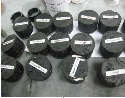
Các mẫu tấm thép với lớp phòng nước đã được chế bị SMA lên trên
