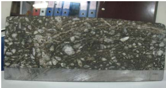
Mẫu tấm thép có phủ BTN Êpôxy dày 41mm sau thí nghiệm ở 16.000.000 lượt tải
