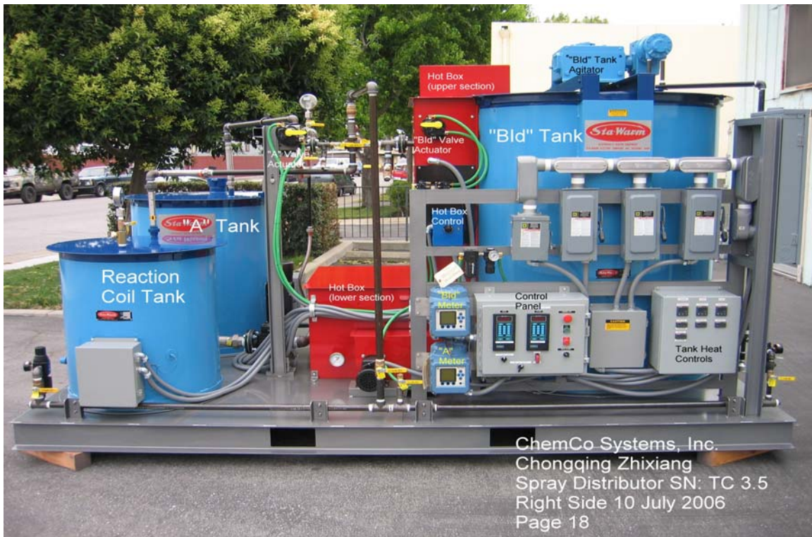
Thiết bị đặc chủng dùng trộn, đun nóng và phun đều lớp phòng nước / dính bám Epoxy
