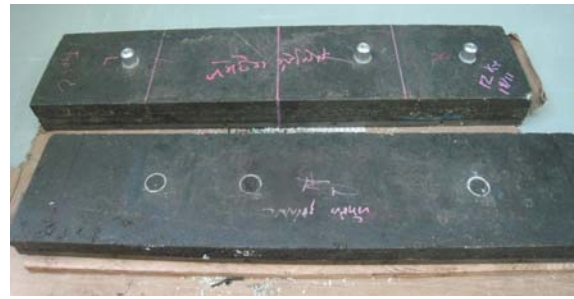
Mẫu tấm thép có phủ BTN Êpôxy dày 41mm sau thí nghiệm ở 16.000.000 lượt tải
