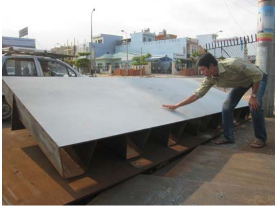
Tấm mẫu được phun cát và sơn kẽm tại công trường cơ khí Công ty 623
