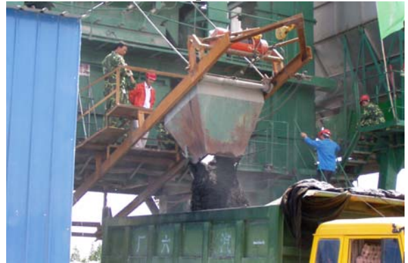
Xả hỗn hợp BTN Asphalt lên xe tải
