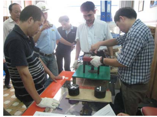
Các mẫu tấm thép với lớp phòng nước đã được chế bị SMA lên trên
